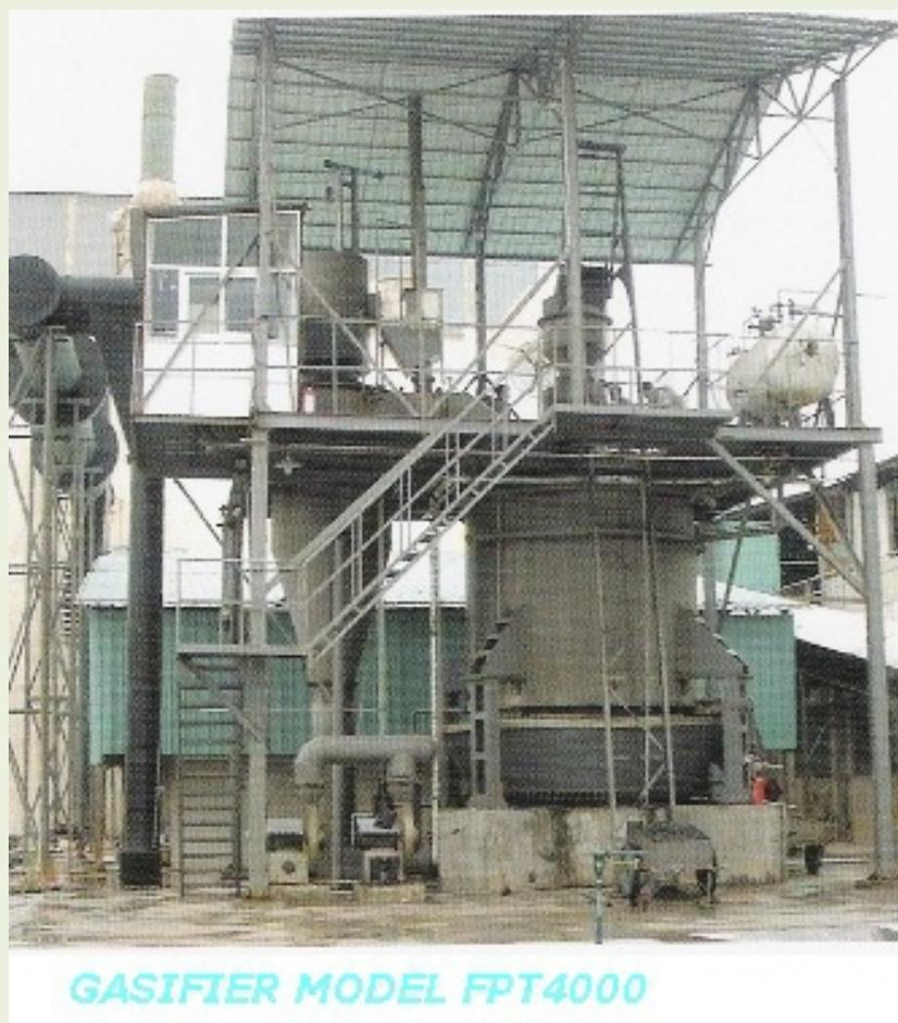
上記写真は、実 FPT4000/ 4 MW モデルの反応器(塔) とサイクロン (ベンチュリー・スクラバー) 部分で、基本的には FPT4800 と同じサイズです。
